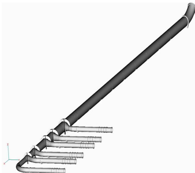
Slika 1. Prostorni model cjevovoda C3 od temelja T9 do agregata
