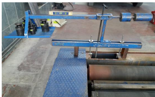
Sl.5. Mjerna oprema za kontrolu uređajaza provjeru sile kočenja kod motornih vozila
